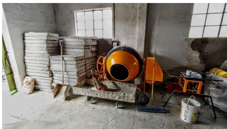
Figura 5: Imagen de la Unidad Productiva del MTE. Pueden verse algunos desarrollos específicos para este proceso productivo: pala para llenado de moldes, batea con ruedas, tapa para la mezcladora, etc.
